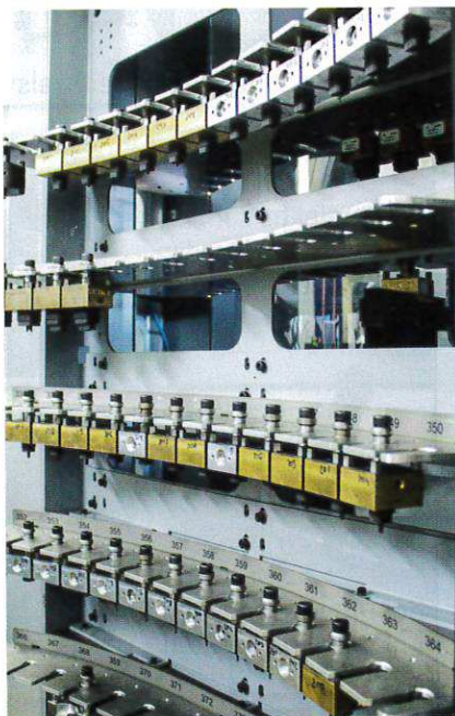
Bild 5: Das von OPS-INGERSOLL integrierte Handlingsystem umfasst 70 Elektrodenplätze und acht Paletten
