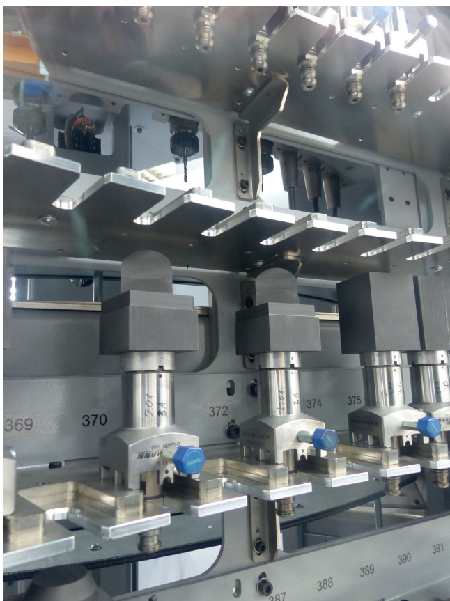
Bild 2: Die Automation MultiChange light PLUS TOOLS ist mit 121 Elektrodenplätzen, acht UPC Palettenplätzen und 33 zusätzlichen Werkzeugplätzen sowie OIPM Chip-Ident ausgelegt
