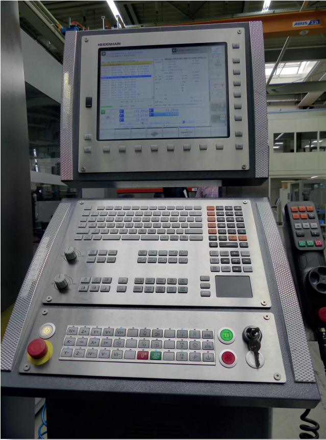
Bild 3: Mit der Heidenhain TNC 640 und der Option Load adaptive Control (LAC) werden anhand des jeweiligen Bauteilgewichts die Regelparameter der Dreh-/Schwenkachse automatisch angepasst und die dynamische Genauigkeit der Rundachse um bis zu 30% erhöht bei zugleich verminderter Bearbeitungszeit
